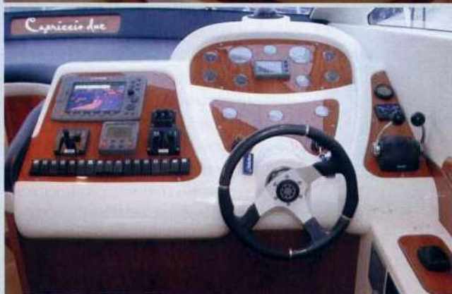
A sinistra, la plancia di comando interna. Il pannello laterale sinistro ospita la strumentazione di navigazione, mentre al centro vi sono gli strumenti motori. Il rivestimento scuro sotto al parabrezza evita fastidiosi riflessi sul vetro.
